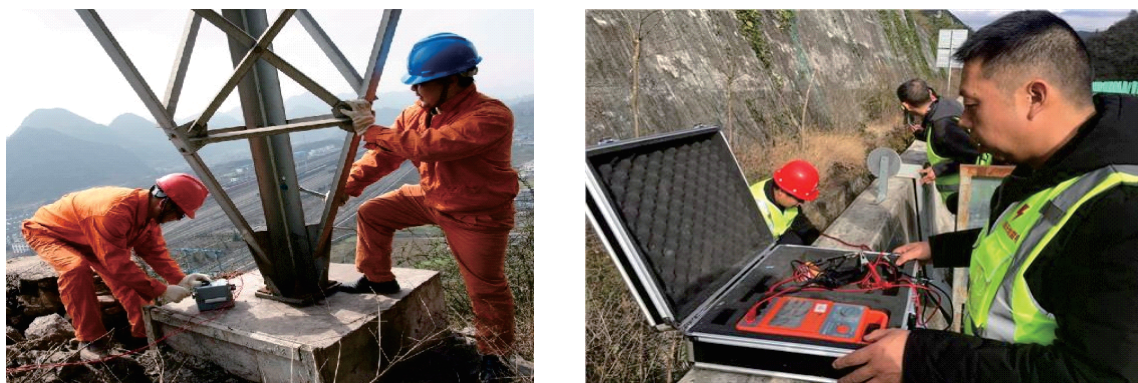
图 6 安全接地系统的常规人工检测场景
